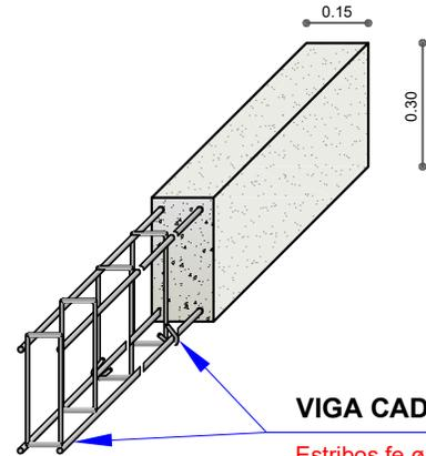
Estribos fe ø 1/4" cada 0.15 m a 0.80 m de cada extremo y cada 0.18 m en la parte central de la Viga.
