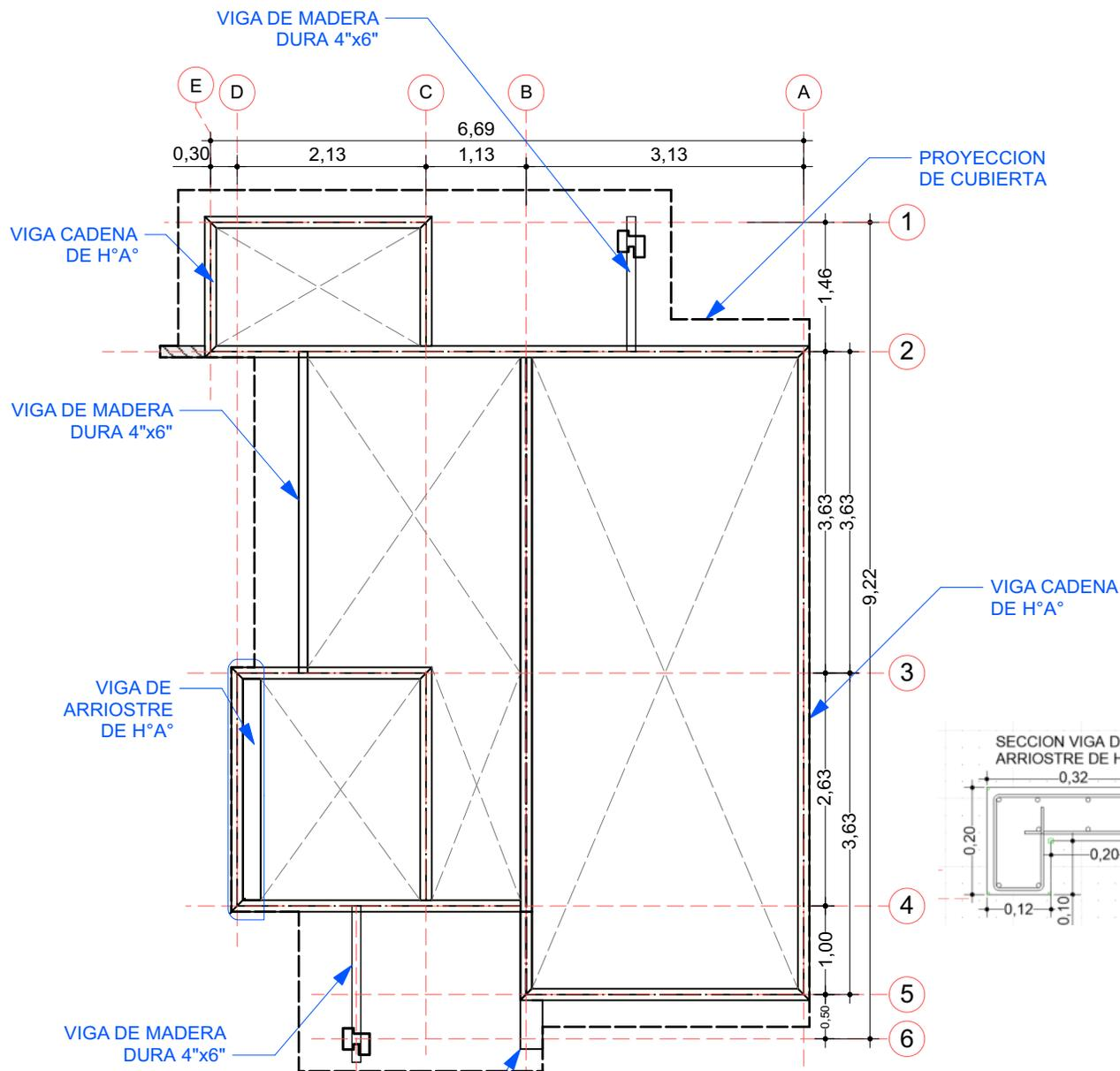
4 PLANO DE VIGA ENCADENADO
