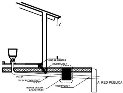
DETALLE SISTEMA DE DESCARGA - CORTE
