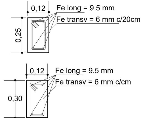
SECCIÓN DE VIGA CADENA DE H°A°
