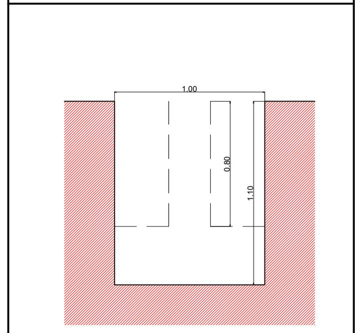
EXCAVACION DE ZAPATA TIPO 1
