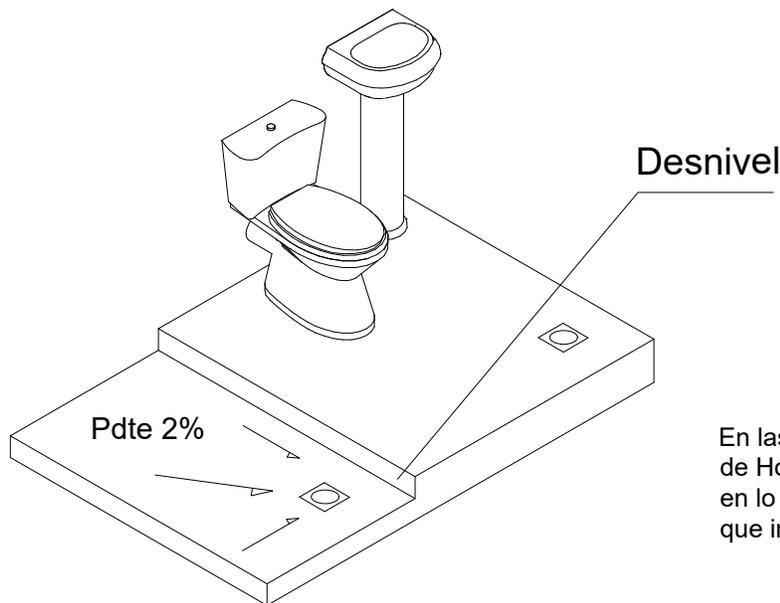
En las Intervenciones con Empedrado y contrapiso de Hormigon debe realizarse un desnivel de 5 cm en lo que corresponde a la ducha, que impida el rebalse de agua en el piso del baño.
