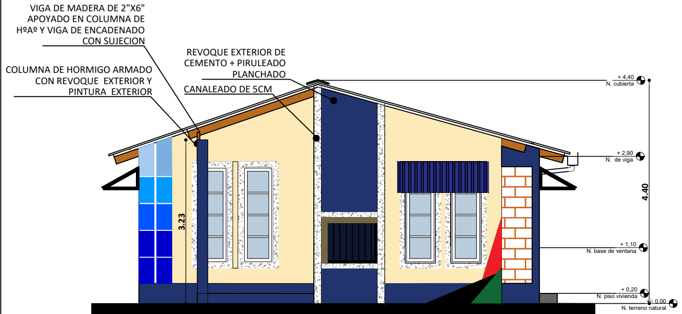
ELEVACION FRONTAL ESC. 1:75
