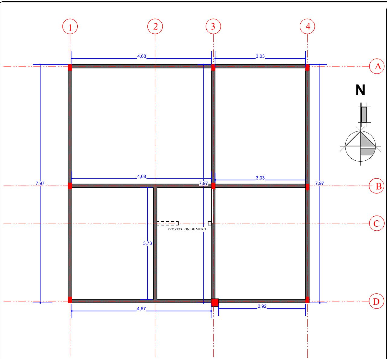
**PLANO DE COLUMNAS Y VIGA ARRIOSTRE**
