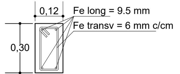
SECCIÓN DE VIGA CADENA DE H°A°
