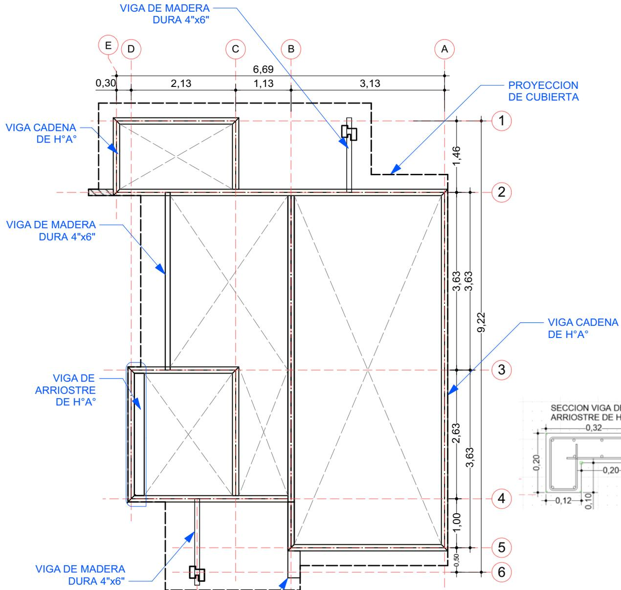
4 PLANO DE VIGA ENCADENADO
