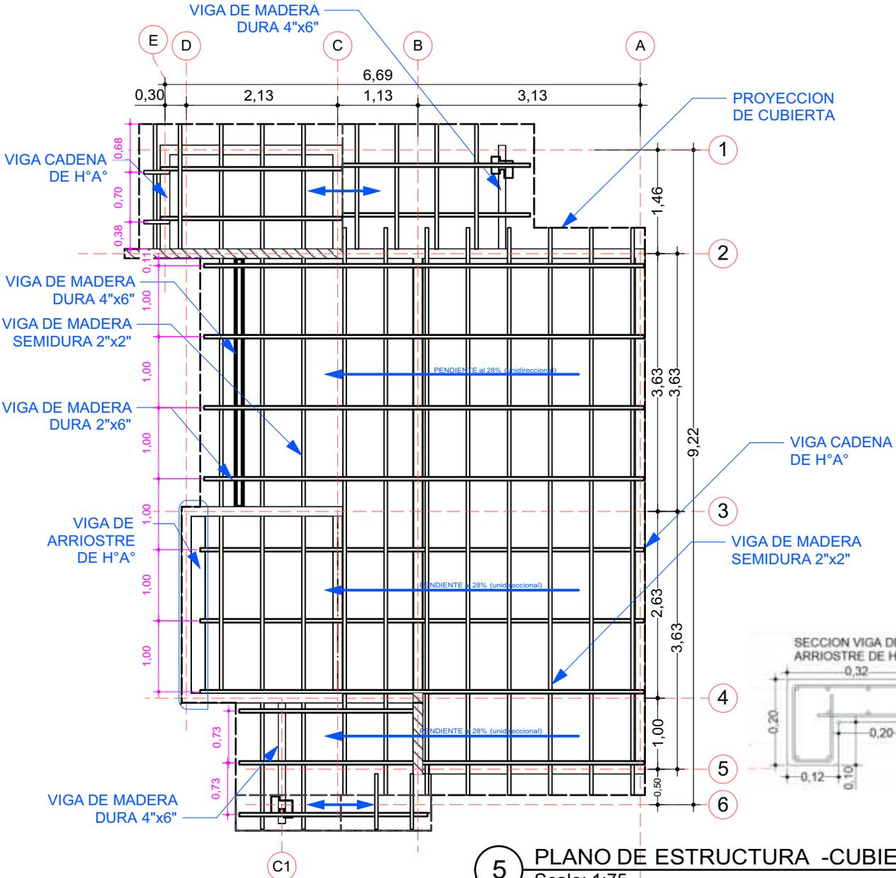
5 PLANO DE ESTRUCTURA -CUBIERTA
