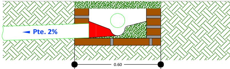
DETALLE CÁMARA DE INSPECCIÓN
