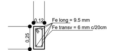
**SECCION DE VIGA CADENA DE H°A°**
