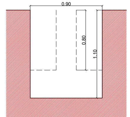
EXCAVACION DE ZAPATA TIPO 2
