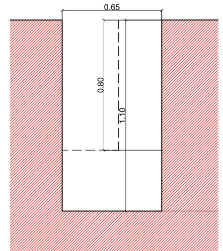
EXCAVACION DE ZAPATA TIPO 1
