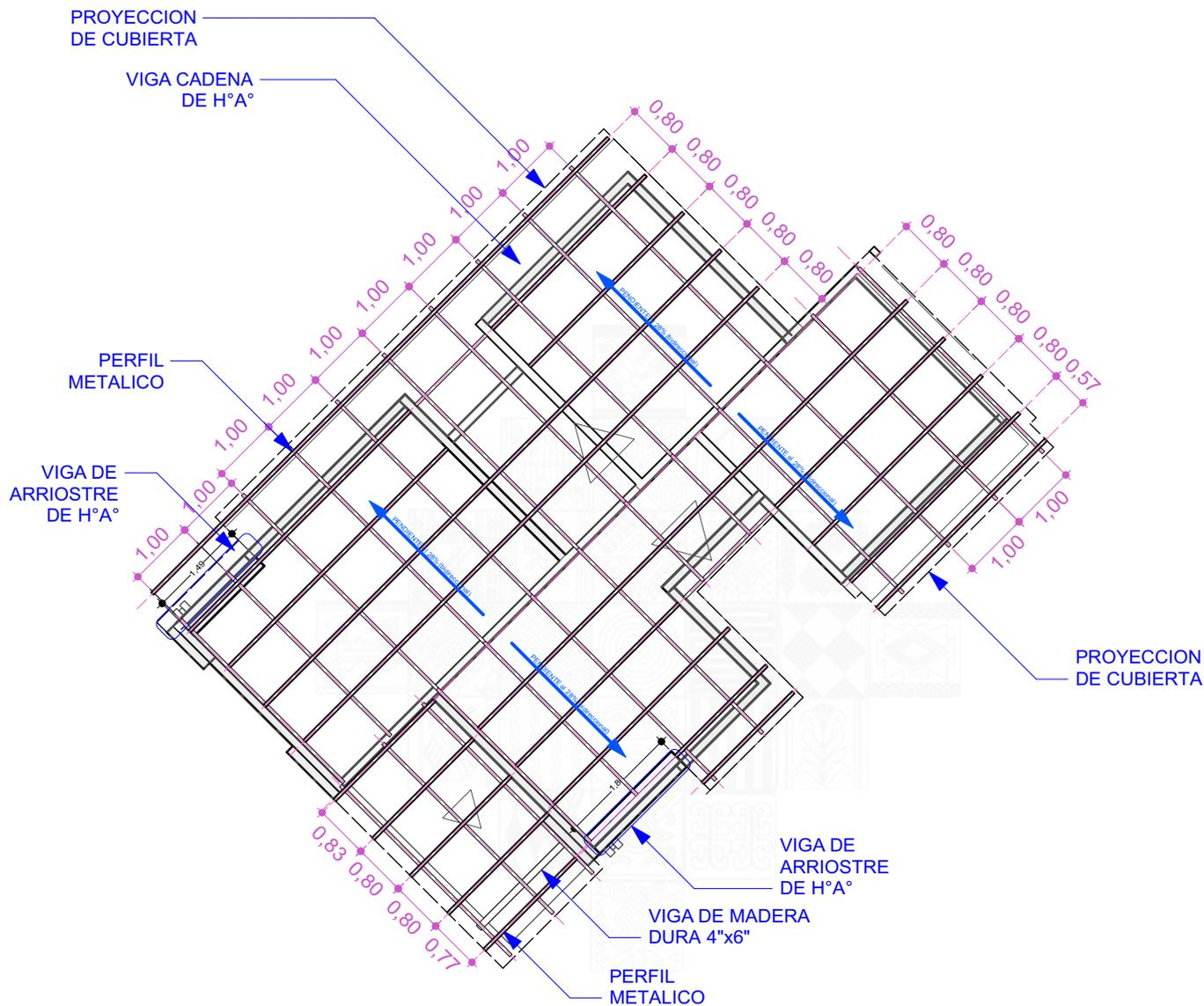
5 PLANO DE ESTRUCTURA METALICA PARA CUBIERTA
