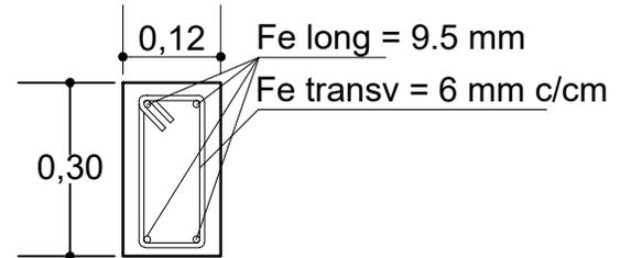
SECCIÓN DE VIGA CADENA DE H°A°
