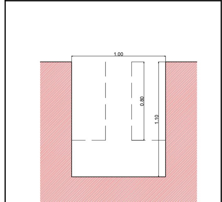
EXCAVACION DE ZAPATA TIPO 1
