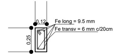
**SECCION DE VIGA CADENA DE H°A°**
