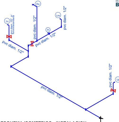
ESQUEMA ISOMETRICO - INSTALACION HIDRAULICA
