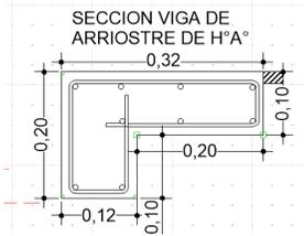
SECCION VIGA CADENA DE H<sup>a</sup>A<sup>a</sup>
