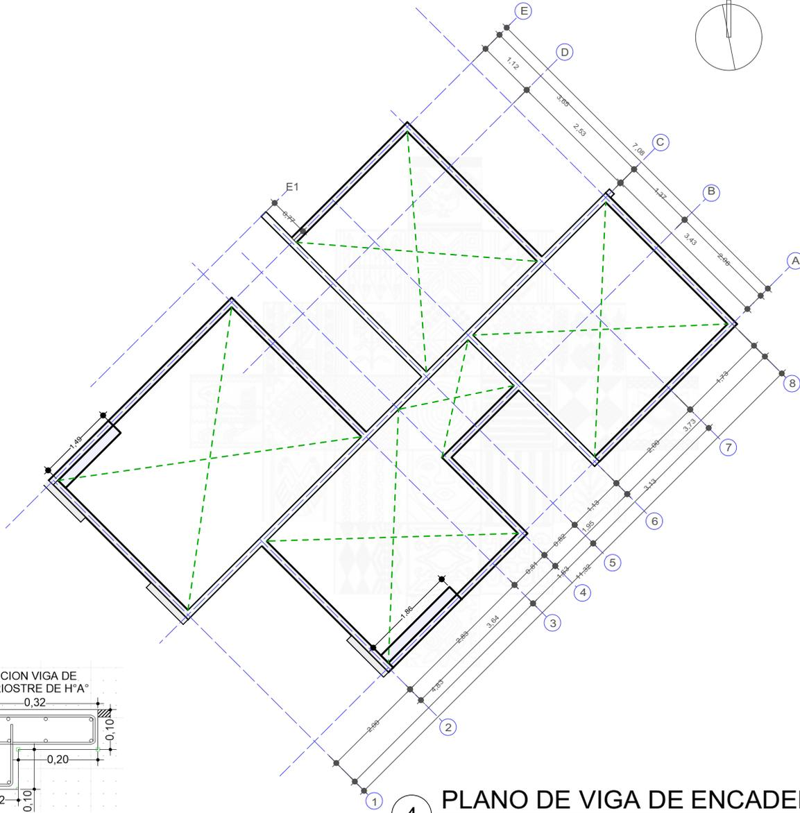
4 PLANO DE VIGA DE ENCADENADO
