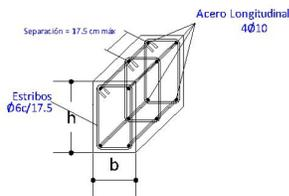
**VIGA DE ARRIOSTRE DE HORMIGON ARMADO DE 0,15X0,20 M**
