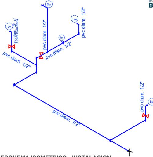
ESQUEMA ISOMETRICO - INSTALACION HIDRAULICA
