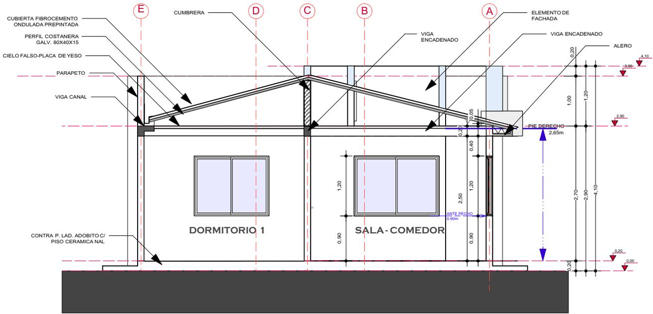
8 CORTE DE SECCION A-A'
