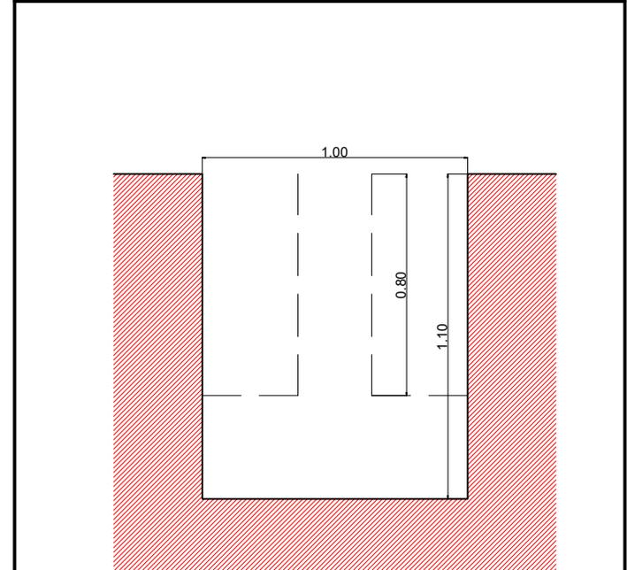
EXCAVACION DE ZAPATA TIPO 1
