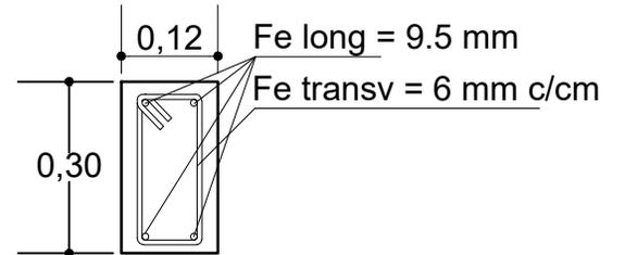
SECCIÓN DE VIGA CADENA DE H°A°
