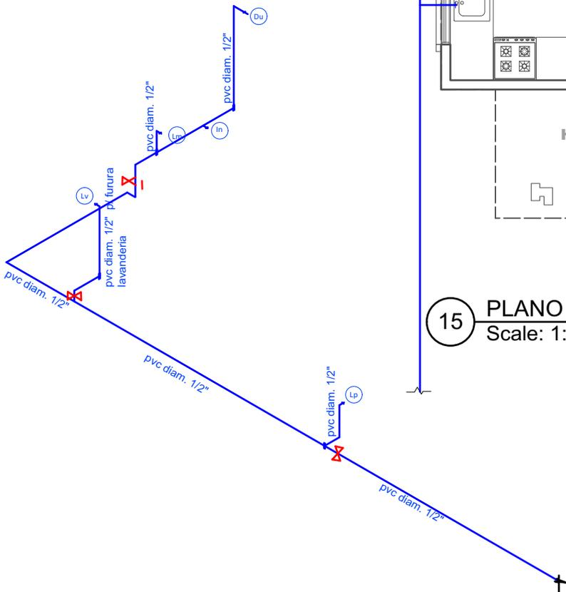
16 PLANO ESQUEMATICO ISOMETRICO - DE INSTALACION HIDRAULICA
