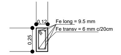
**SECCION DE VIGA CADENA DE H°A°**
