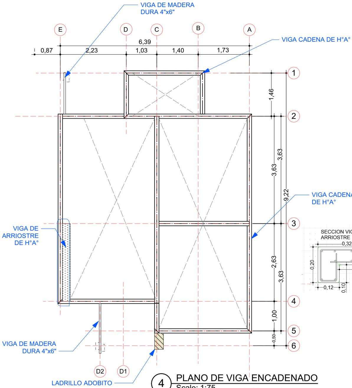
**4 PLANO DE VIGA ENCADENADO**
