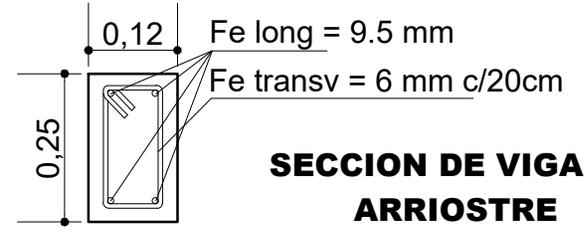
**SECCION DE VIGA DE ARRIOSTRE**
