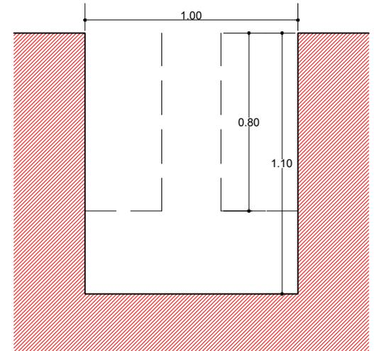
**EXCAVACION DE ZAPATA TIPO 1**
