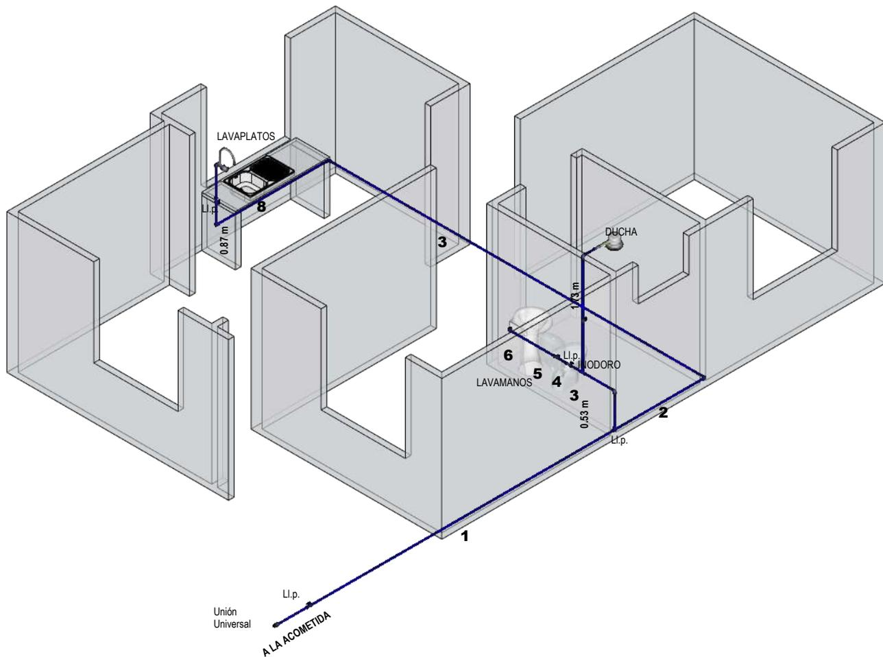
**INST. HIDRAULICA ISOMETRICO**
