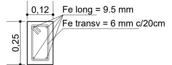
SECCIÓN DE VIGA CADENA DE H°A°
