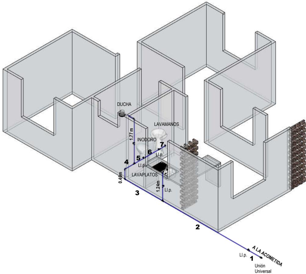
**INST. HIDRAULICA ISOMETRICO**
