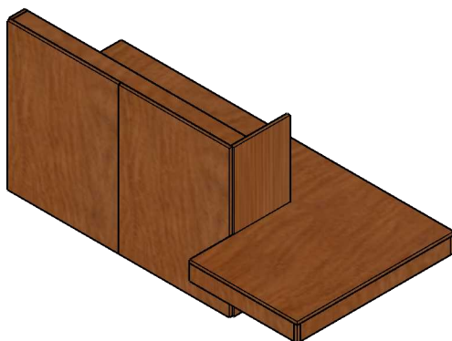
ISOMETRIA CAJONERÍA BAJA DE MELAMINA 18 mm COCINA
