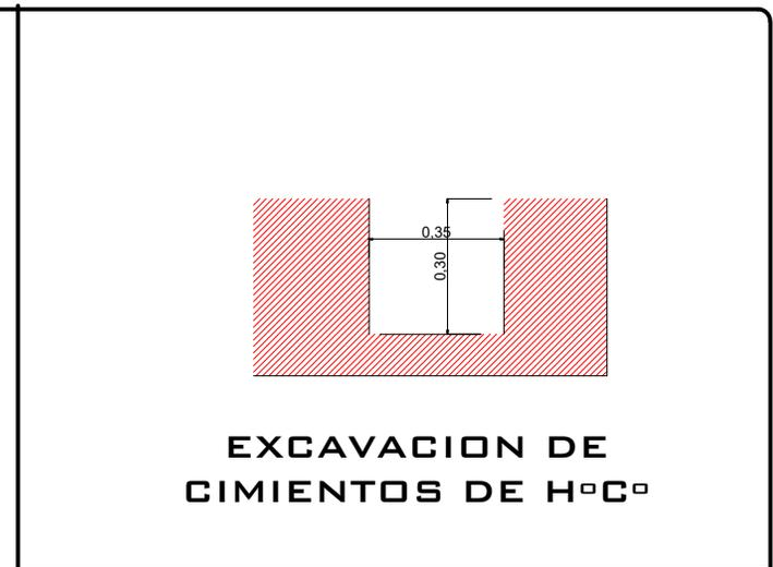
EXCAVACION DE CIMENTOS DE H<sup>o</sup>C<sup>o</sup>
