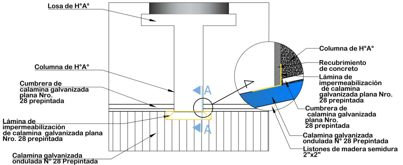
**DETALLE DE IMPERMEABILIZACIÓN DE CUBIERTA**
