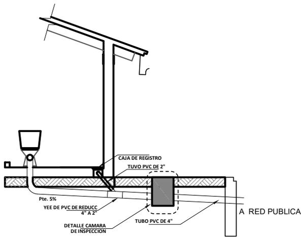
DETALLE SISTEMA DE DESCARGA - CORTE
