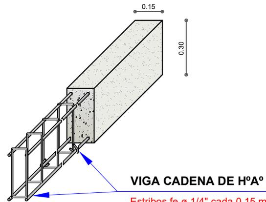
Estribos fe Ø 1/4" cada 0.15 m a 0.80 m de cada extremo y cada 0.18 m en la parte central de la Viga.
