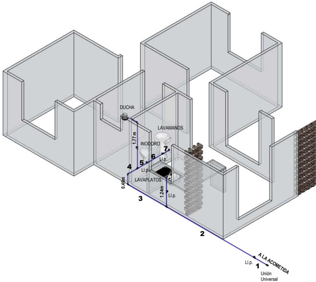
**INST. HIDRAULICA ISOMETRICO**
