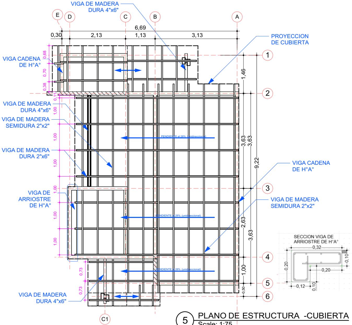
**5 PLANO DE ESTRUCTURA -CUBIERTA**
