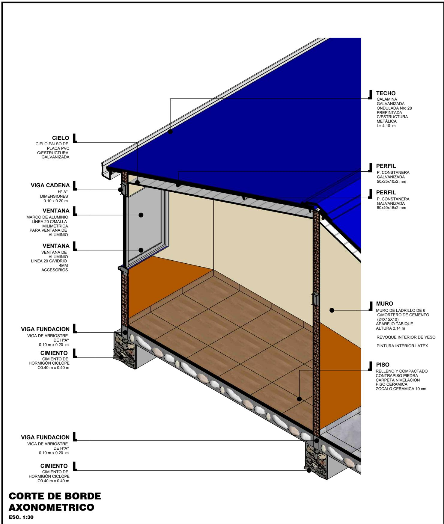
**CORTE DE BORDE AXONOMETRICO**
