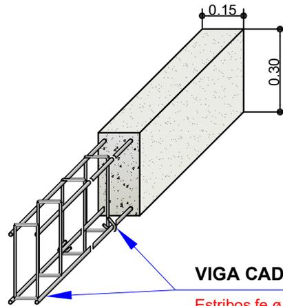
Estribos fe ø 1/4" cada 0.15 m a 0.80 m de cada extremo y cada 0.18 m en la parte central de la Viga.
