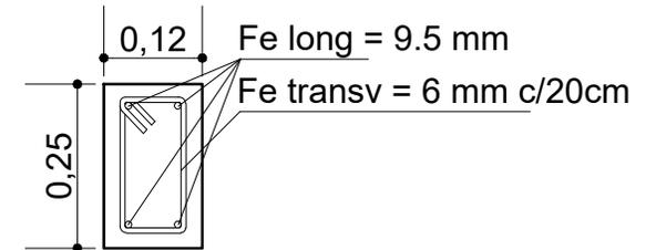
SECCIÓN DE VIGA CADENA DE H°A°
