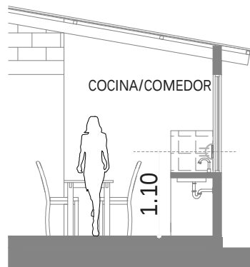
DETALLE ALTURA DE TOMACORRIENTES
