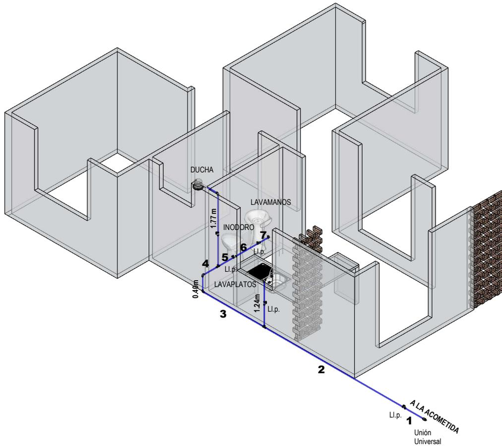
**INST. HIDRAULICA ISOMETRICO**
