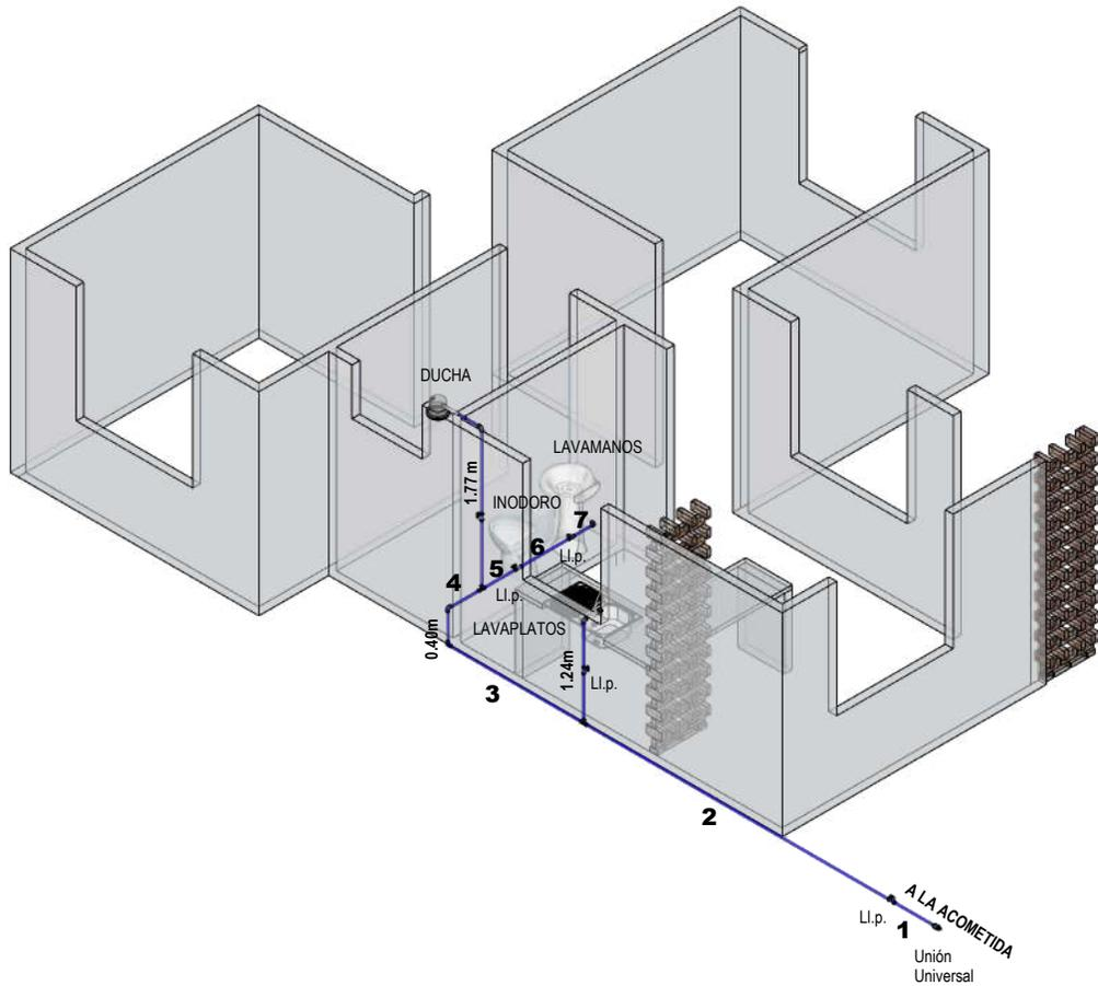
**INST. HIDRAULICA ISOMETRICO**
