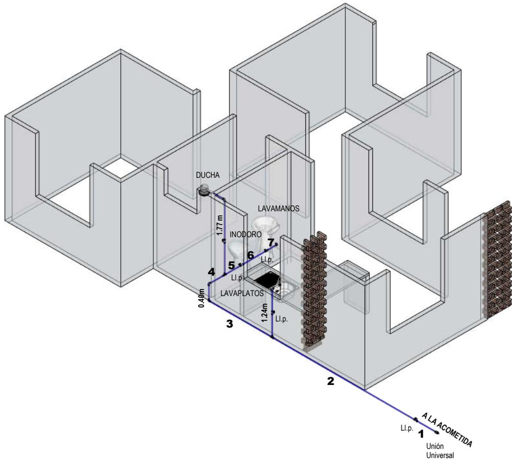
**INST. HIDRAULICA ISOMETRICO**
