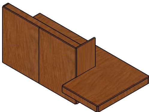
ISOMETRIA CAJONERÍA BAJA DE MELAMINA 18 mm COCINA
