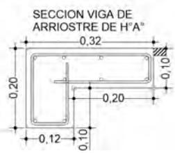
SECCION VIGA CADENA DE H'A.
