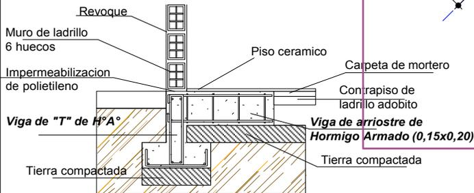
**VIGA DE ARRIOSTRE DE HORMIGON ARMADO DE 0,15X0,20 M**
