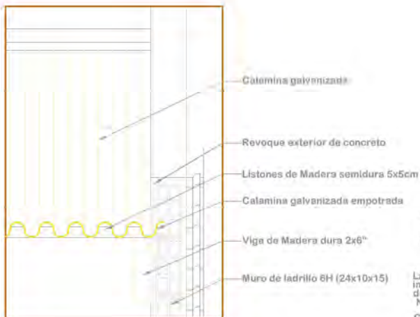
DETALLE EMPOTRADO DE CALAMINA ESC: 1:15
