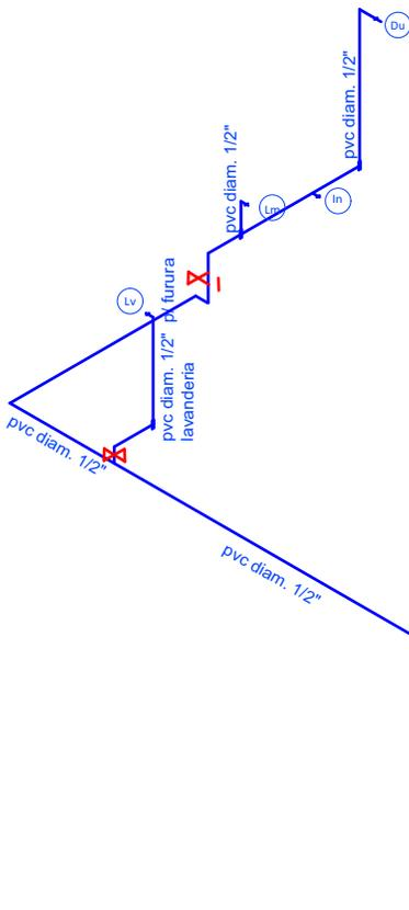
16 PLANO ESQUEMATICO ISOMETRICO - DE INSTALACION HIDRAULICA
