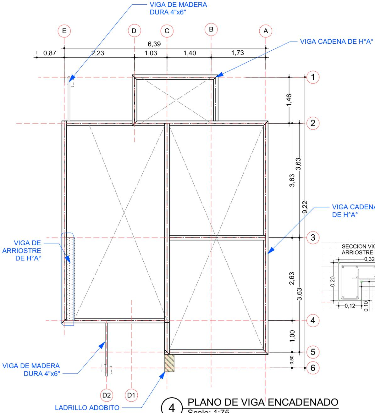
**4 PLANO DE VIGA ENCADENADO**
