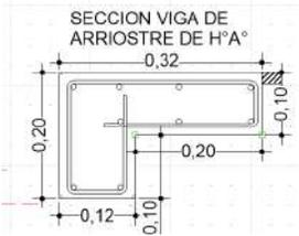
SECCION VIGA CADENA DE H°A°
